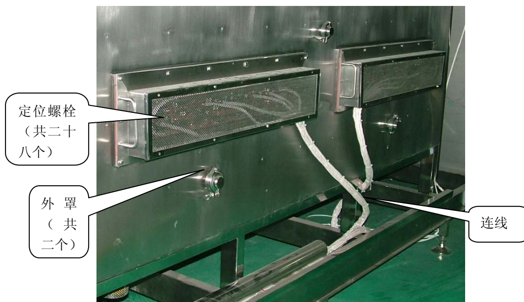
图 6-23 电加热管的检测与更换（1）
