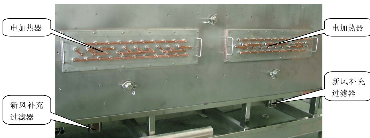
图 6-14 电加热管和新风补充过滤器
